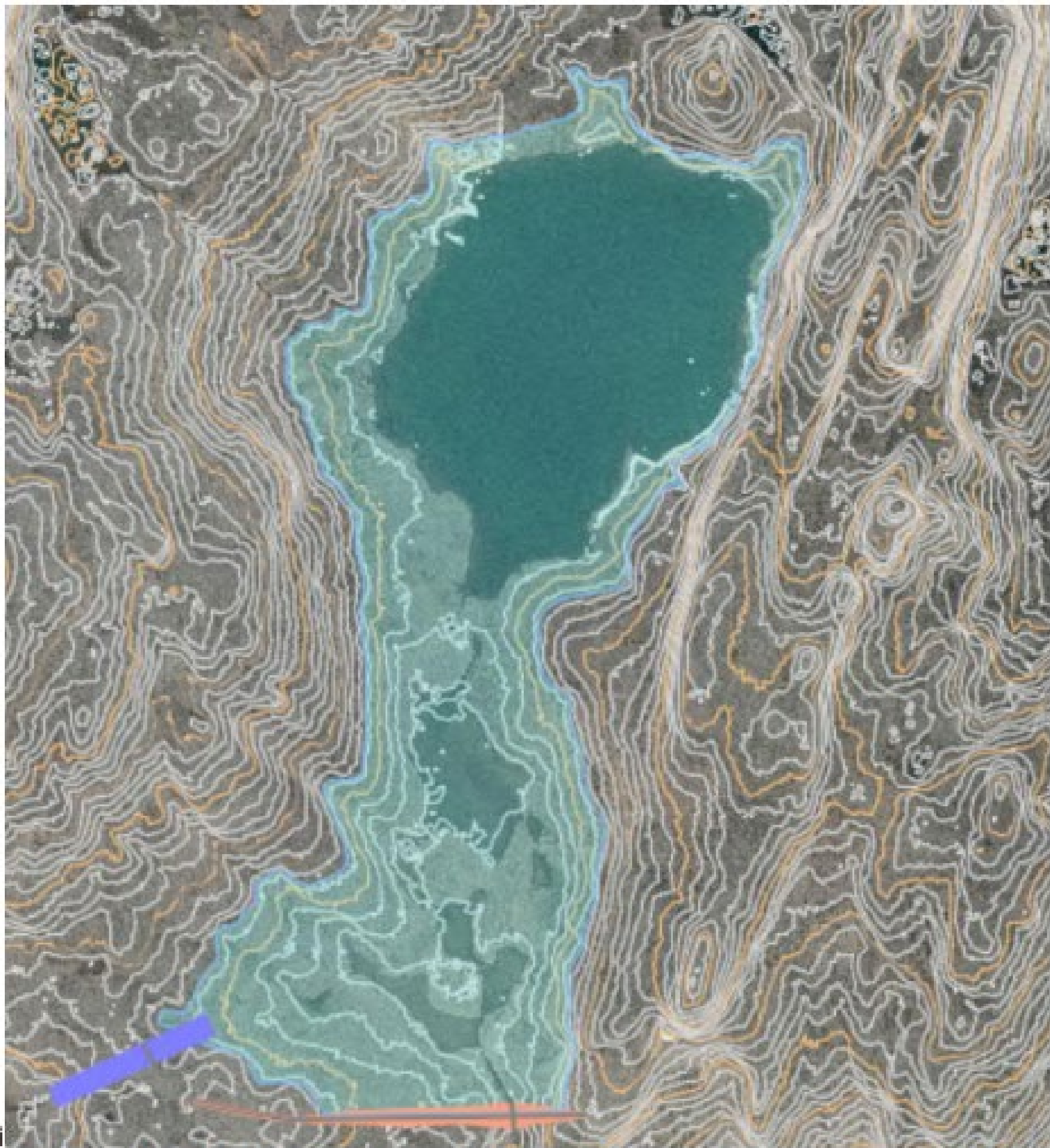
Mynd 9 Miðlunarlón í Svartagilsvatni. Lónhæð 453 m y.s. Stífla appelsínugul. Yfirfallsskurður blá lína. 2 m á milli hæðarlína.
