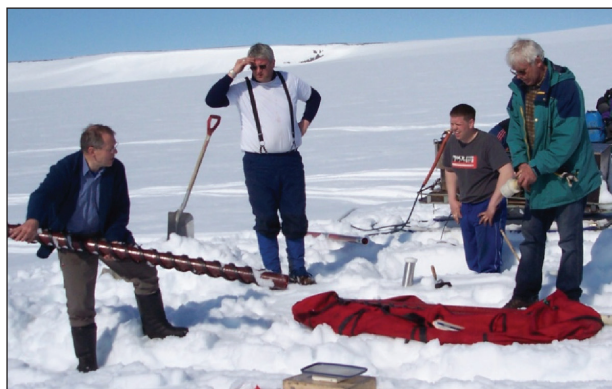
Kjarnaborinn tæmdur reglulega og eðlisþyngd snævarins mæld.
