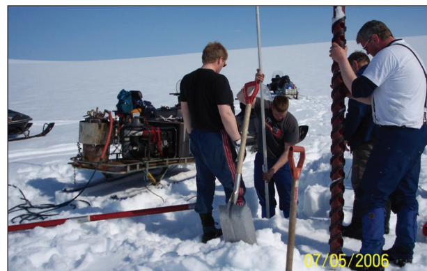
Álstöng komið fyrir, bæði staðsetning og þykkt af nýjum snjó skráð.
